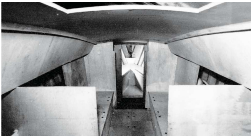
Октябрь 1980 года. Палуба закончена и даже оклеена стеклотканью. Теперь дело за внутренней отделкой. А ей можно и зимой заниматься...
