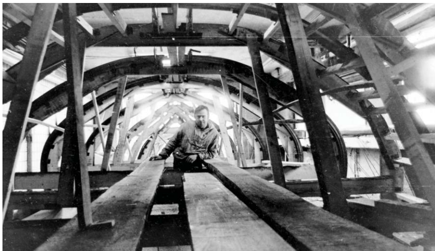
Февраль 1979. Юра внутри лодки. Основные шпангоуты уже стоят на лекалах и ждут весны, чтобы их можно было склеить.
