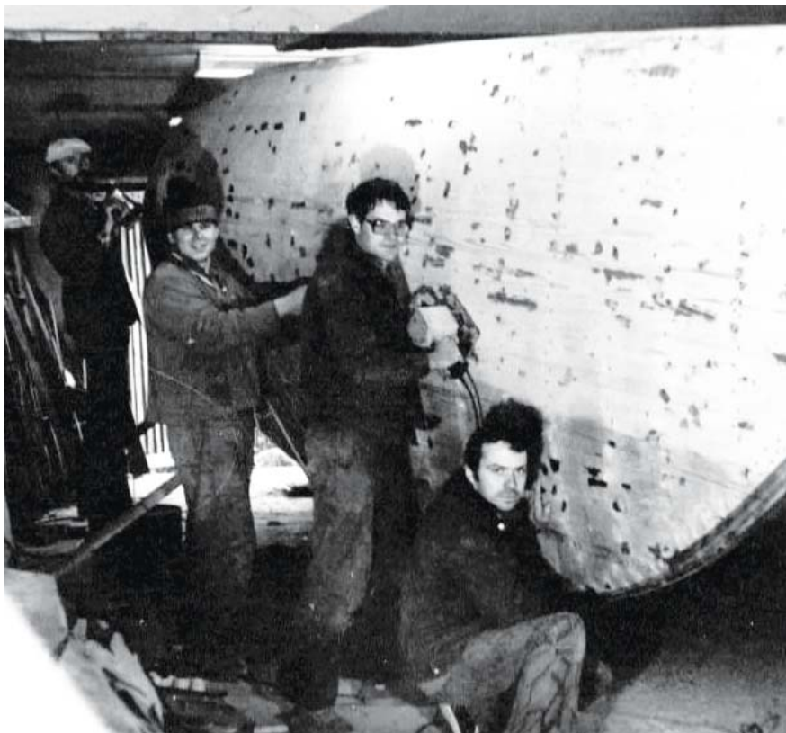
Приводим корпус яхты в надлежащий вид для последующей оклейки стеклотканью. Работа монотонная, пыльная, но необходимая. Слева направо: Валера Деймонтович, Лёша Грищенко, Игорь Мироненко, Юра Бондарь.
